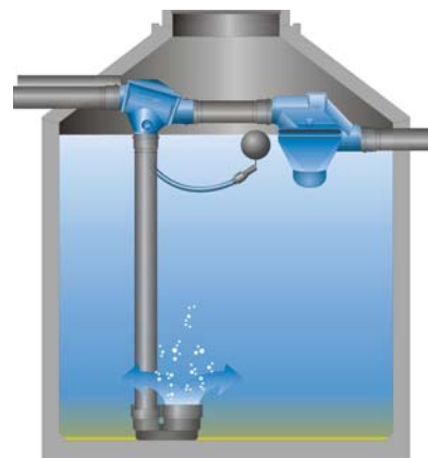
Installation des Regenwasserfilters im Regenwasserspeicher
