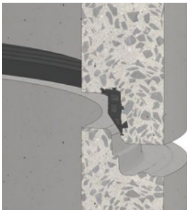
Verbindung ECOPLAN mit werkseitig integrierter Dichtung und umlaufender Betonzentrierleiste zur Lastübertragung
